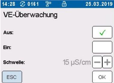
Abbildung 52 – Einstellungsmenü zur VE-Wasser-Überwachung
