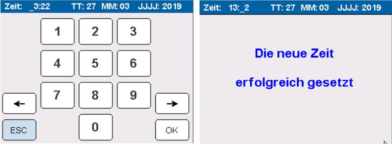
Abbildung 49 – Menü zur Einstellung Datum & Uhrzeit mit Bestätigungsmeldung
