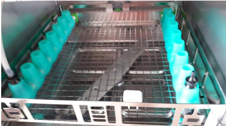
Abbildung 14 – Oxides Thermo Tab (Artikelnummer 100 921) in den Beladungskorb einlegen
